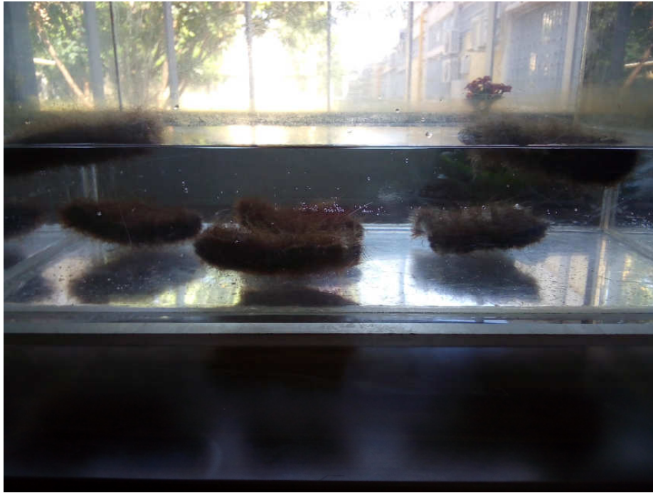
Εικόνα 27. Πείραμα (5B ΔΥΝΑΜΙΚΑ) 2ο δείγμα [μποστά σειρά] βυθίστηκε στα 5'
