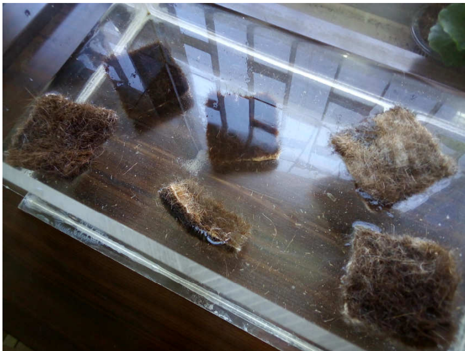
Εικόνα 28. Πείραμα (5B ΔΥΝΑΜΙΚΑ) 2ο δείγμα [μποστά σειρά] στα 5' αρχίζει να βυθίζεται
