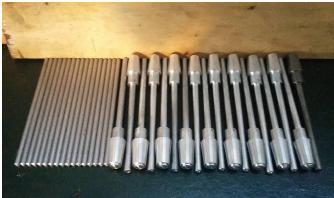
Εικόνα 25 : Τελική μορφή δοκιμίων (Αριστερά τα δοκίμια για την δοκιμή σε εφελκυσμό-Δεξιά τα δοκίμια για δοκιμή σε κόπωση.)
