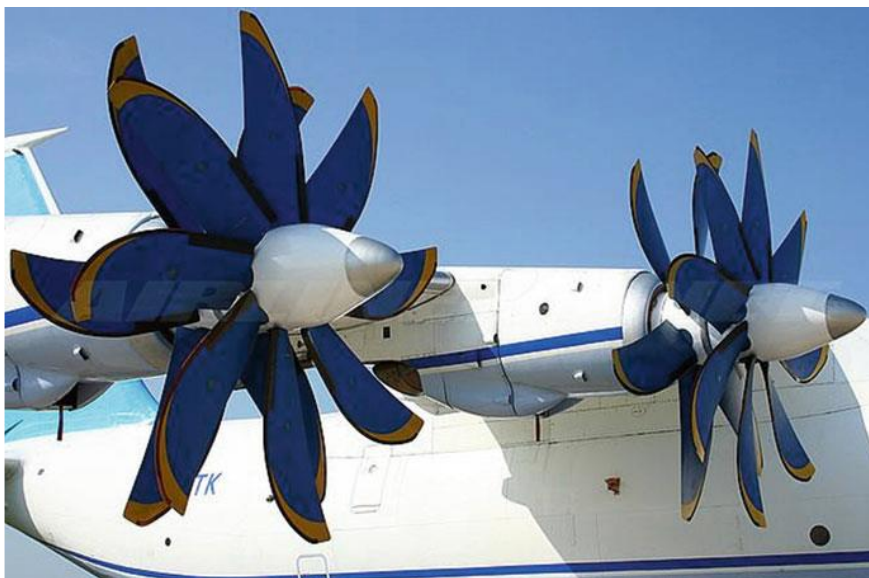
Εικόνα 1.3.2.1.2 (δ) «Ο κινητήρας propfan Ivchenko-Progress D-27 του An-70»
