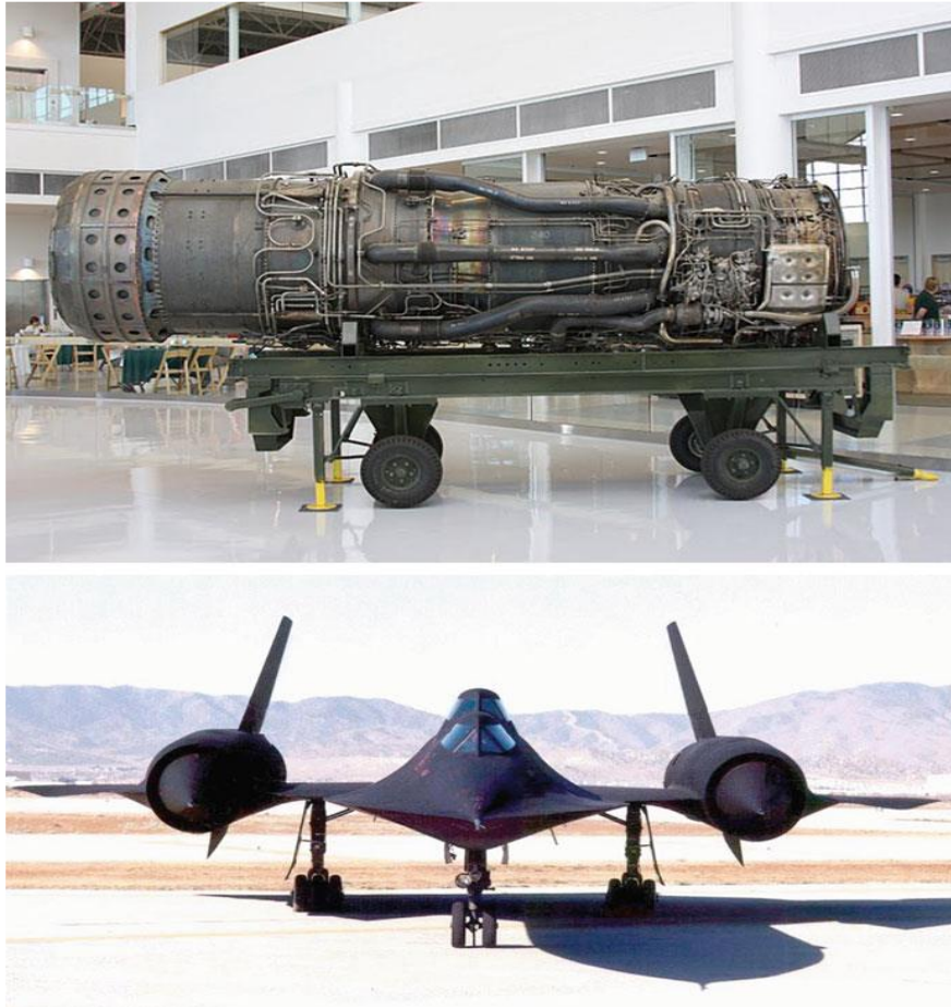
Εικόνα 1.3.2.2.2 (στ) «Κινητήρας turbo-ramjet J58 της Pratt&Whitney και αεροσκάφος SR-71»
