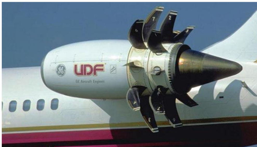
Εικόνα 1.3.2.1.2 (γ) «Κινητήρας propfan του αεροπλάνου GE-36 της General Electric»
