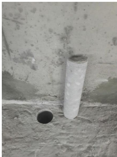
Σχήμα 3.9 Σύστημα λήψης πυρήνων σκυροδέματος.
