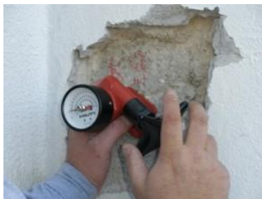
Σχήμα 3.7 Όργανο που χρησιμοποιείται για την εξόλκευση ήλου.
