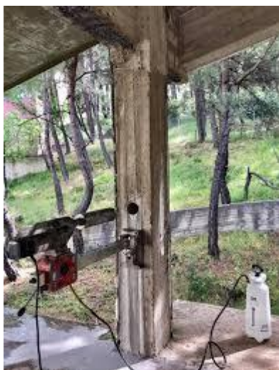
Σχήμα 3.9 Σύστημα λήψης πυρήνων σκυροδέματος.
