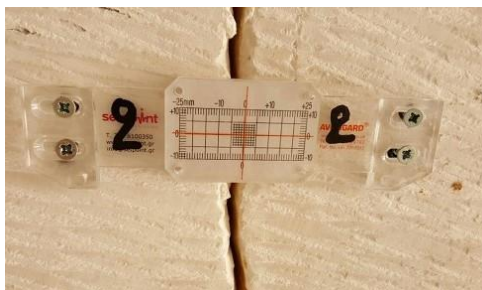
Σχήμα 3.3 Ρωγμόμετρο για τη μέτρηση εύρους και εξέλιξης της ρωγμής.
