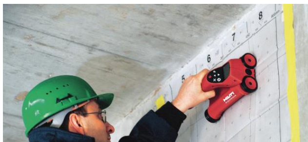
Σχήμα 3.8 Συσκευή για τον εντοπισμό οπλισμού.
