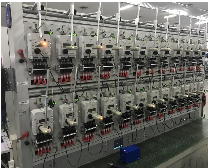
Εικόνα 33: Τράπεζα ελέγχου έξυπνων μετρητών
