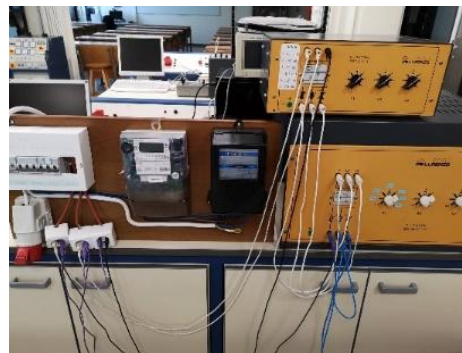
Εικόνα 38: Πείραμα 1 με ρυθμιζόμενες αντιστάσεις και πηνία
