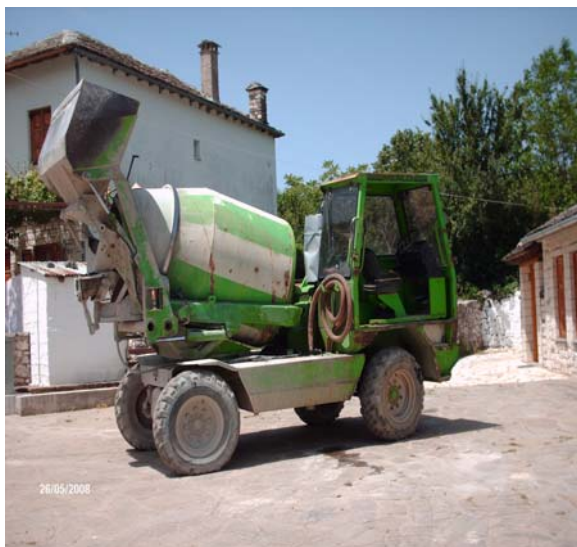
Εικόνα 64: Μηχάνημα 1μ3 για σκυρόδεμα- δύσκολη μεταφορά σκυροδέματος
