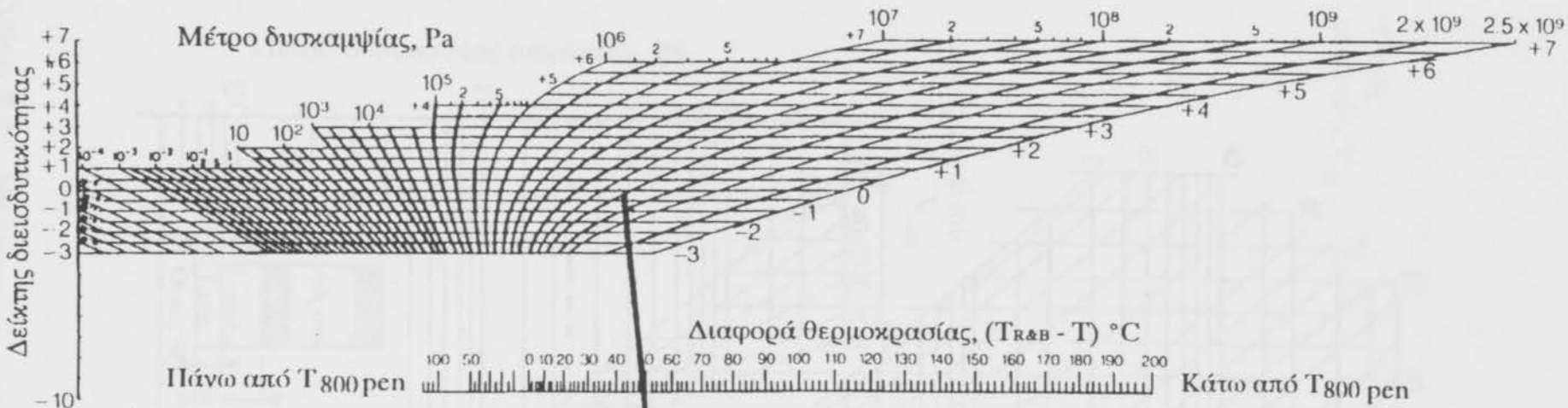
Σχήμα 6.2 Νομογράφημα Van der Poel για τον καθορισμό του μέτρου δυσκαμψίας ( S_{bit} ) της ασφάλτου.
