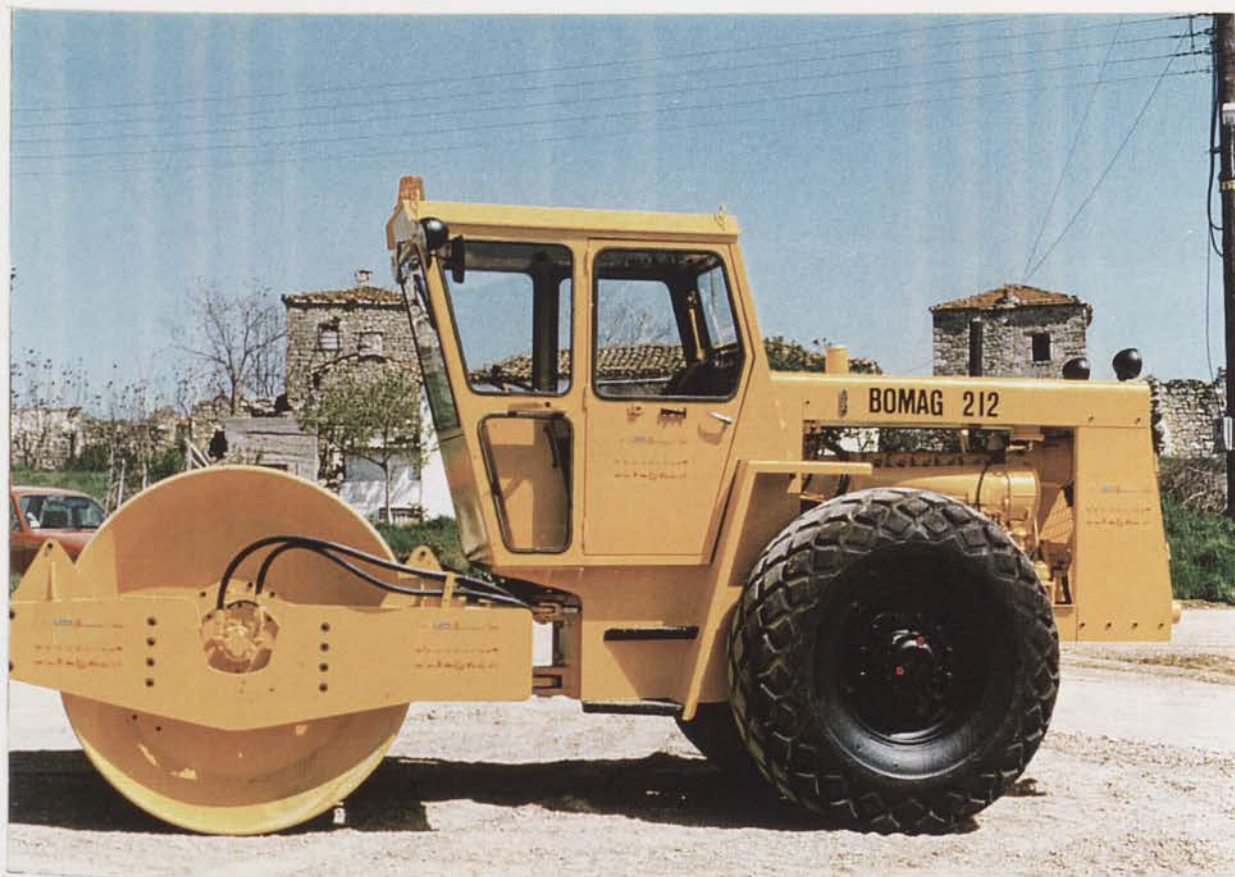
Φωτογραφία 9. Δονητικός οδοστρωτήρας με ένα κύλινδρο
