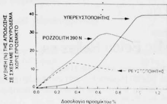
Σχήμα 2: Παράδειγμα καμπύλης απόδοσης - δοσολογία για ένα ρευστοποιητή και για τον POZZOLITH 390 N
