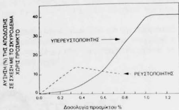
Σχήμα 1: Παράδειγμα καμπύλης απόδοσης - δοσολογία για ένα ρευστοποιητή και για ένα υπερευστοποιητή
