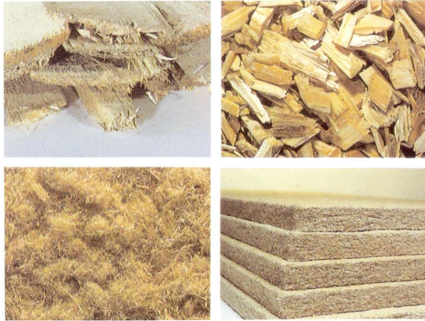
Εικόνα 7 Ως πρώτη ύλη για την κατασκευή ξυλόμαλλου χρησιμοποιείται το ξύλο και σε συγγενή προϊόντα χρησιμοποιούνται ροκανίδια, λεπτά κλαδιά, καλάμια, άχυρα και άλλα φυτικά προϊόντα σε υπό μορφή ινών.
